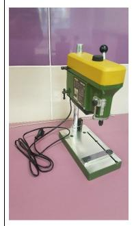
Стол и корпус станка изготовлены из литого под давлением алюминия;
